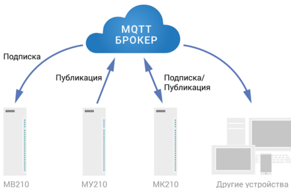
Рисунок 6.2 – Структурная схема обмена по протоколу MQTT
